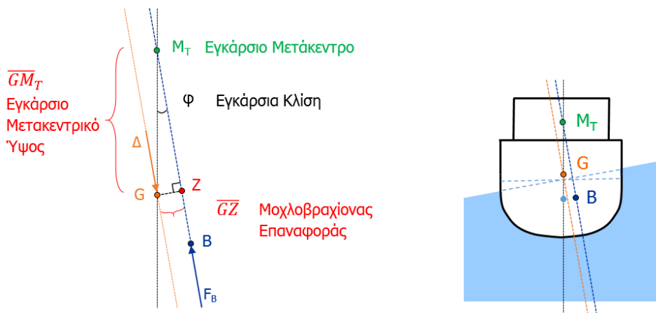
Σχήμα 4. Στο τρίγωνο αρχικής ευστάθειας ενός πλοίου φαίνεται η σχέση του μοχλοβραχίονα επαναφοράς και του μετακεντρικού ύψους σε μικρές γωνίες κλίσης.
