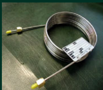
ΠΑΚΕΤΑΡΙΣΜΕΝΕΣ ΣΤΗΛΕΣ (packed columns)
