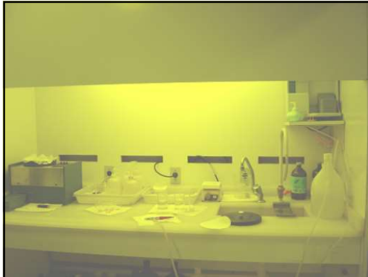
capela (iluminação amarela) para deposição e revelação do fotoresiste
