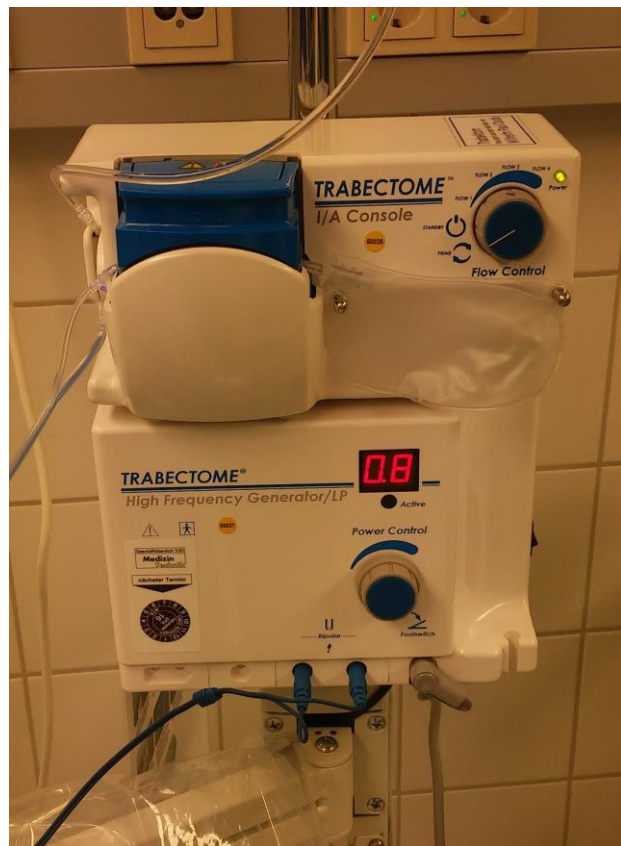
Abbildung 4: Konsole des Trabektoms: Aspiration/Irrigation im oberen Bildteil, Generator im unteren Bildteil
