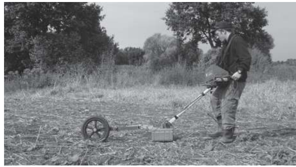
Abb. 277 Georadarmessungen mit der 400 MHz-Antenne auf der Teilfläche 1.
