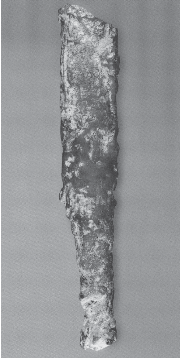
Abb. 68 Schliengen-Liel ‚Schnepfenstöße‘: An leicht gewölbter Ofenwand entlang geflossener ca. 15 cm langer Schlackenzapfen.
