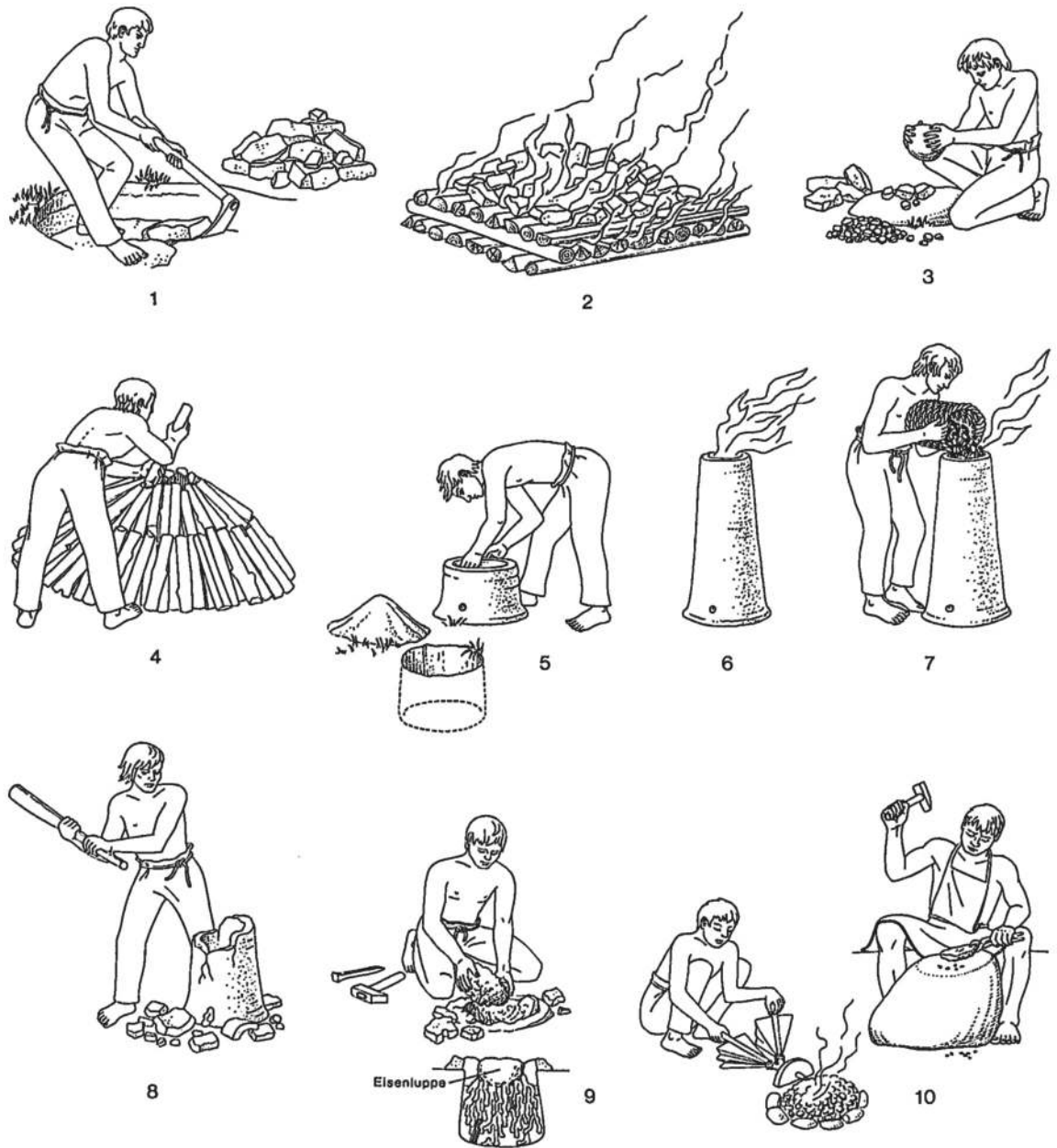
Abb. 9 Bildliche Darstellung der Arbeiten und Prozesse bei der Verhüttung am Beispiel eines Schachtrennofens mit eingetiefter Schlackengrube und der Nutzung von Raseneisenerz. 1: Abbau von Raseneisenerz; 2: Rösten des Raseneisenerzes; 3: Zerkleinern des gerösteten Erzes; 4: Holzkohleproduktion in einem Meiler; 5: Ausheben einer Schlackengrube und Aufbau des Ofenschachtes; 6: Vorbrennen des Ofenschachtes; 7: Beschicken des Rennofens mit Holzkohle und Erz; 8: Zerschlagen des Ofenschachtes nach Beendigung der Verhüttung(?); 9: Herausbrechen der Eisenluppe; 10: Reinigen und Verdichten des Luppen Eisens.
