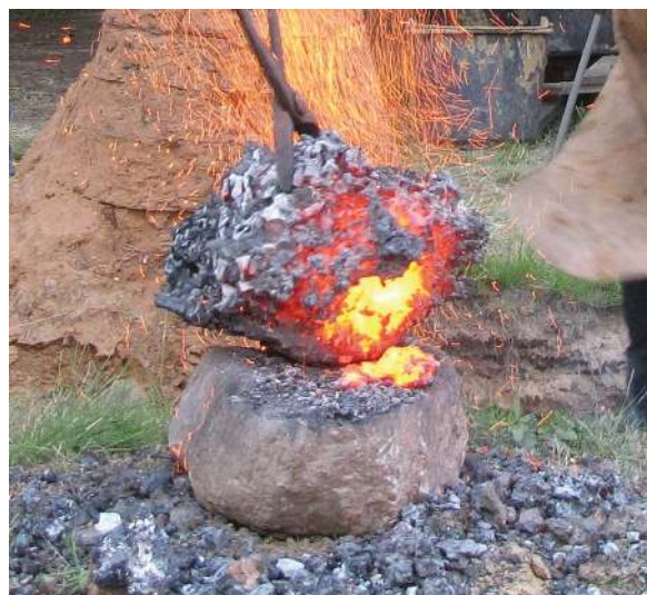
Abb. 12 Bearbeitung einer glühenden Eisenluppe unmittelbar nach deren Entfernen aus dem Rennofen.
