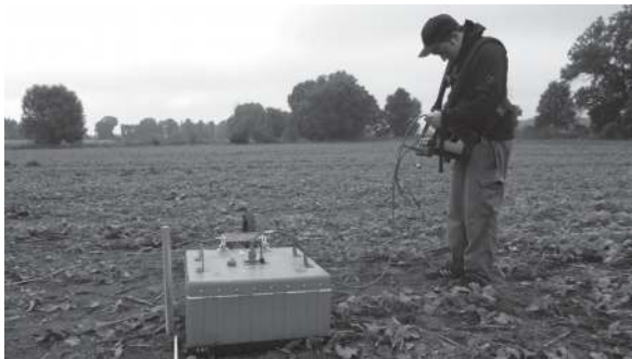
Abb. 279 Die 200 MHz-Antenne im Einsatz auf den Profilen des abgesteckten Bohrtransekts.
