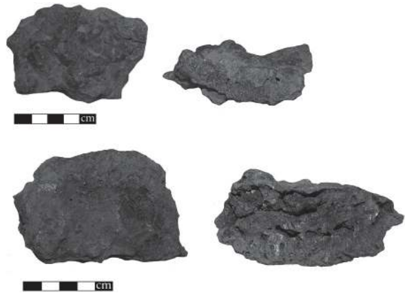
Abb. 350 Kowalowice, Fdst. 3. Verarbeitungsschlacken Nr. 146-1 (oben) mit einem Gewicht von 251 g und Nr. 146-2 mit einem Gewicht von 457 g.
