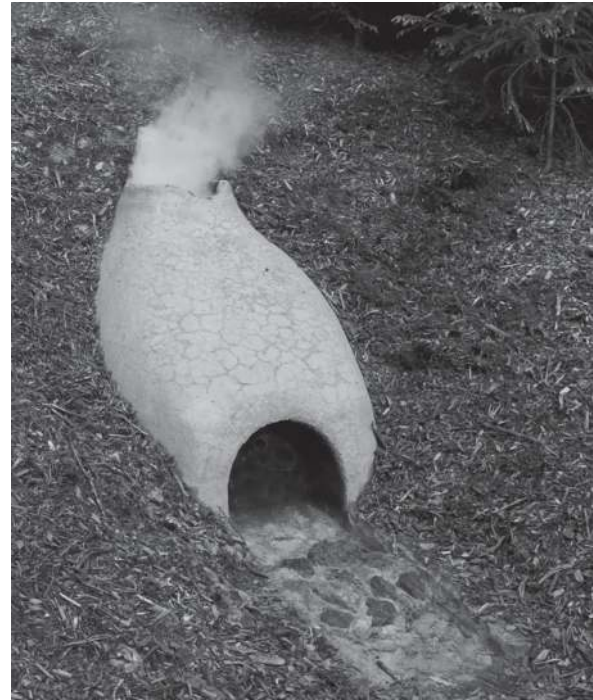
Abb. 40 Rekonstruktion eines Rennofens vom Siegerländer Typ.
