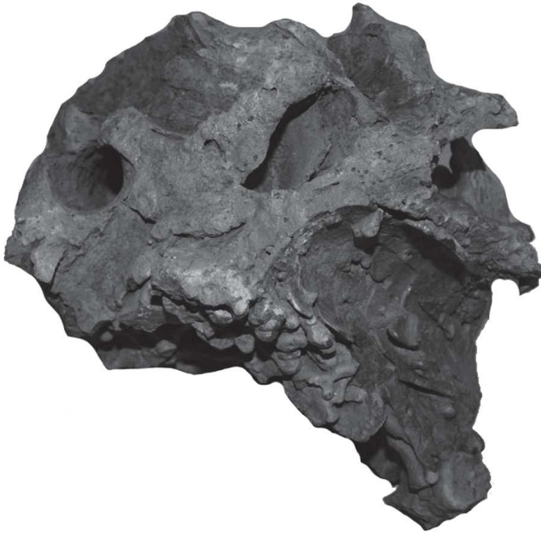
Abb. 333 Pielgrzymowice 5. Schnitt 4. Schlacke aus dem Rennofen (Bef. 1/4) mit Negativabdrücken und Hohlräumen von runden Hölzern und Ästen. o. M..
