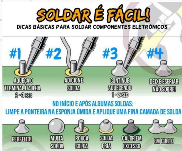
Figura 12 – Tutorial de soldagem de componentes eletrônicos.
