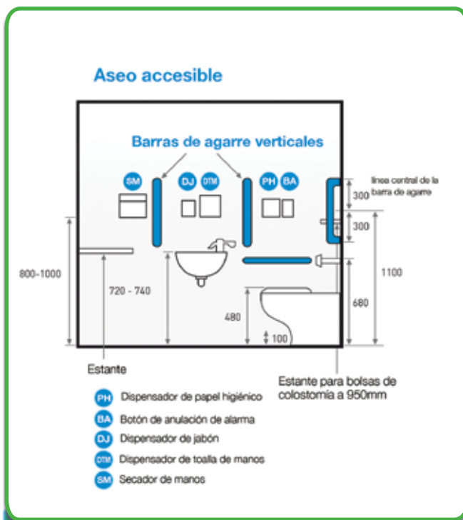
Ilustración 25: Distribución de un aseo accesible
