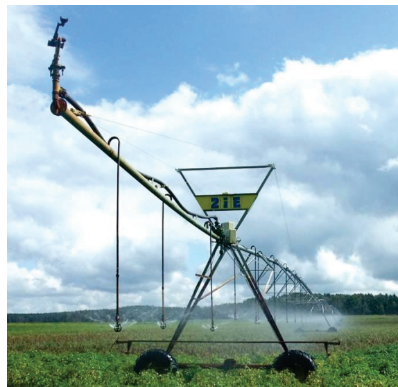
Abb. 2-1: Schema einer Kreisberegnungsanlage (beregnete Fläche blau, unberegnete Restfläche grün) und Foto einer Kreisberegnung mit Endregner
