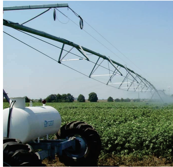
Abb. 2-2: Schema (beregnete Fläche blau, unberegnete Restfläche grün) und Foto einer Linearberegnungsanlage
