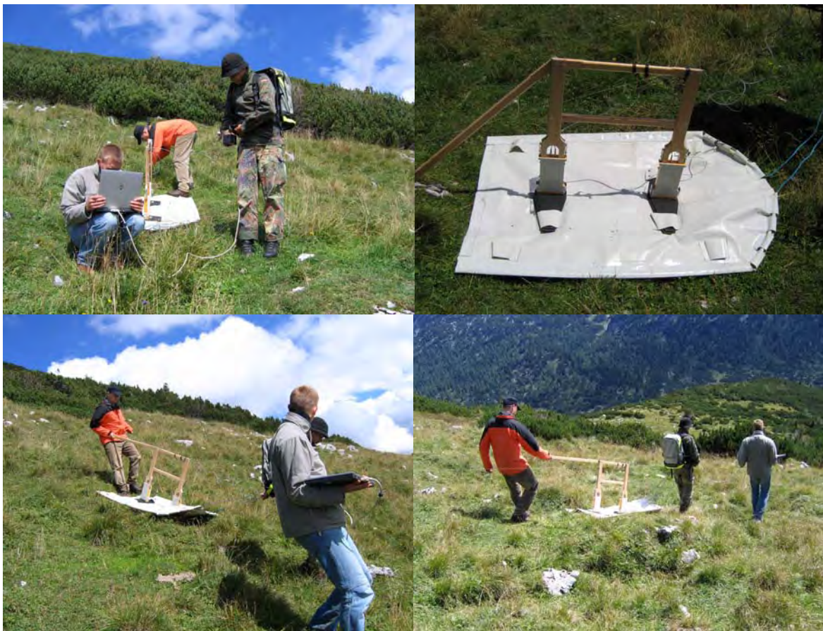
Foto 1-4: Das Bodenradar Gerät und Antennen der Firma MALA GeoScience. Untersuchungen am Weitschartenkopf – Pratikum 9/2006
