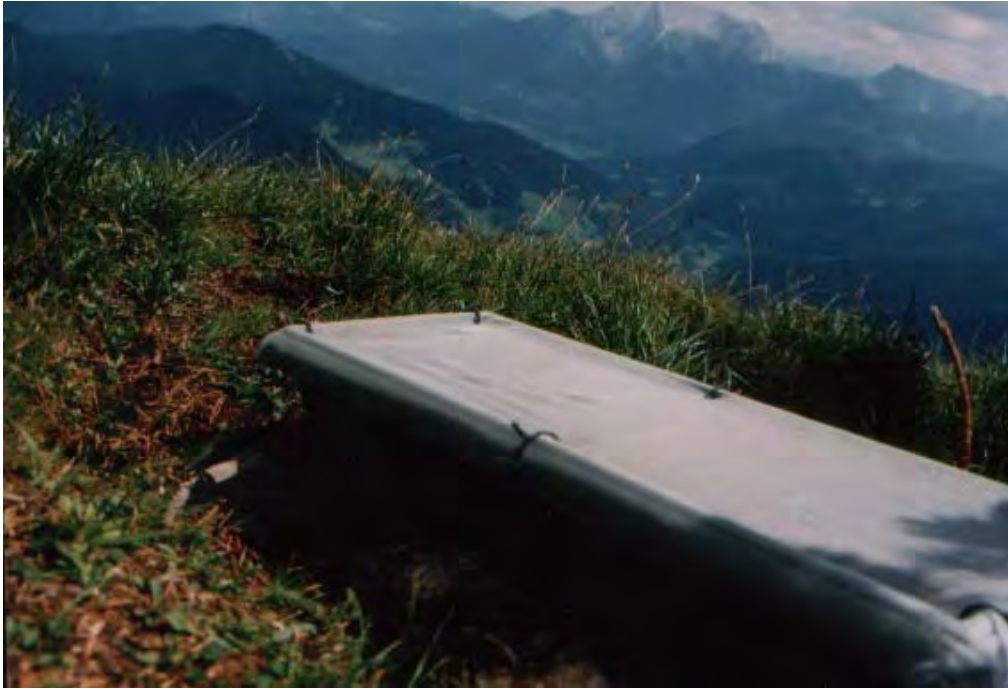
Foto 8: Wartung des selbstkonstruierter Flugstaub-Probenahmekasten (Typ 2) zur Messung von Flugstaubeinträgen im Hochgebirge am Edelweisslahner1800m
