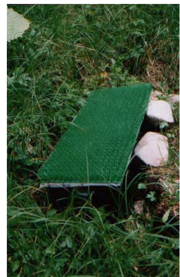
Foto 7: Selbstkonstruierter Flugstaub-Probenahmekasten (Typ 1) zur Messung von Flugstaubeinträgen im Hochgebirge
