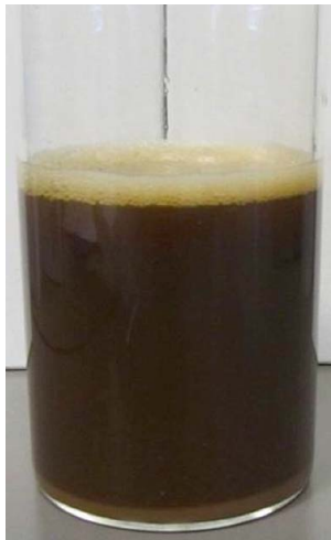
Abbildung II.3.1: Fraktion eines bei 200°C mit Wasser vorbehandelten Weizenstrohs
