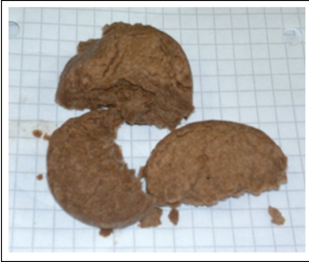
Abb. 49: Faserrückstand aus Siebzentrifuge. Die erzielten Eckdaten sind in Tab. 24 zusammengestellt (Quelle: BTS)
