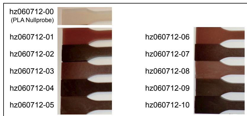
Abb. 234: Prüfkörper aus PLA mit unterschiedlichen Mengen an Lignin und Fasern (Quelle: ICT)
