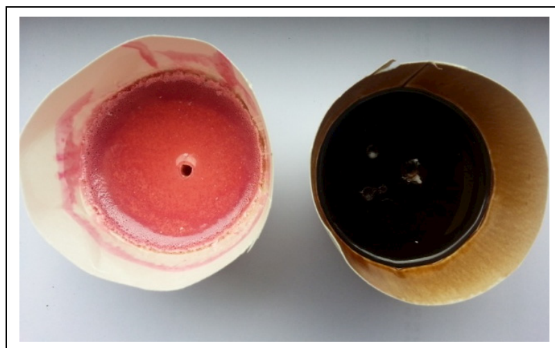
Abb. 185: Farbunterschied zwischen unmodifiziertem (links) und Lignin-haltigem Schaumharz (20 %, rechts) (jeweils gehärtet ohne Treibmittel) (Quelle: Dynea)
