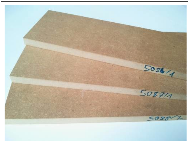
Abb. 143: Faserplatten der Laborversuchs-Bindemittel mit 10 % bzw. 20 % Phenolsubstitution sowie unmodifizierte Referenz (Quelle: Dynea)
