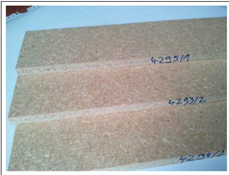
Abb. 153: Spanplatten der Laborversuche-Bindemittel mit 10 % bzw. 20 % Phenolsubstitution sowie unmodifizierte Referenz (Quelle: Dynea)
