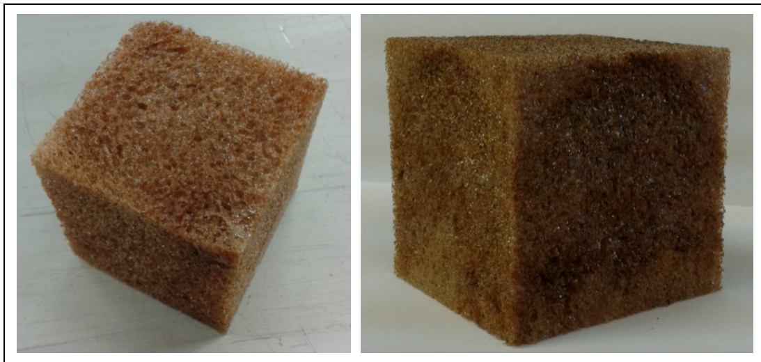
Abb. 220: Polyurethanschäume auf Basis von Organosolv-Lignin (Quelle: Uni-HH/TI)
