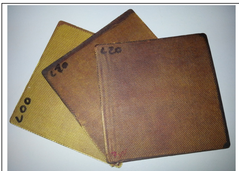
Abb. 163: Glasfaserlaminat mit unmodifiziertem Phenolharz- im Vergleich mit Lignin-haltigen Bindemitteln (10 % bzw. 20 %) (Quelle: Dynea)
