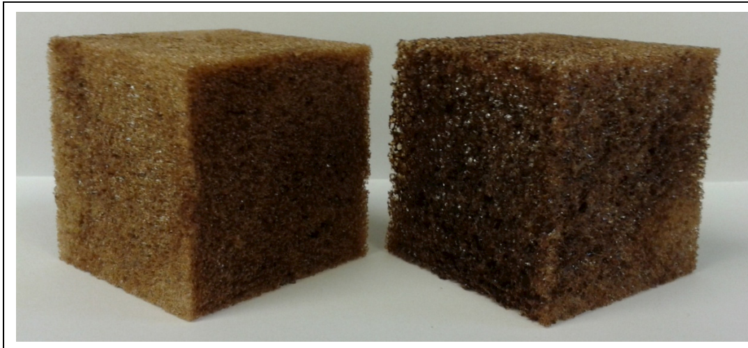
Abb. 224: Polyurethanschäume aus Organosolv-Lignin (links) und hydroxypropyliertem Organosolv-Lignin (Quelle: Uni-HH/TI)
