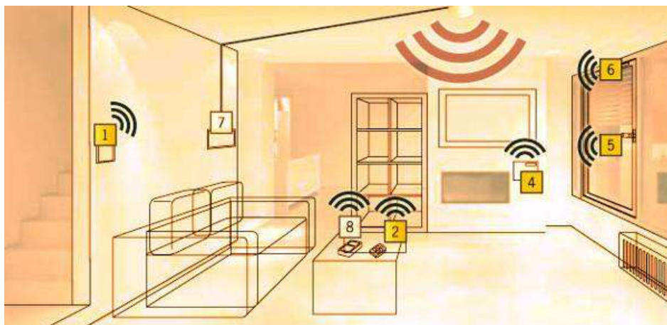
Abb. 1 Szenario einer kontextsensitiven Gebäudeautomatisierung mit mobilen, energieautarken Bedienelementen
