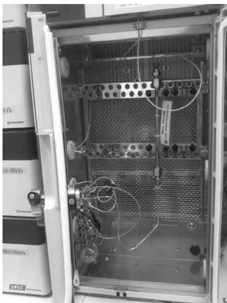
Figura 27 – Compartimento do cromatógrafo para CLAE onde fica a coluna
