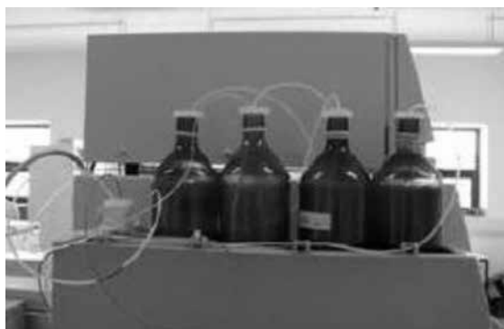
Figura 29 – Frascos utilizados como reservatório para fase móvel na CLAE
