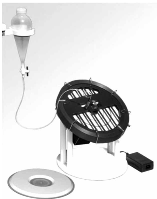
Figura 19 – Equipamento utilizado na técnica chromatotron
