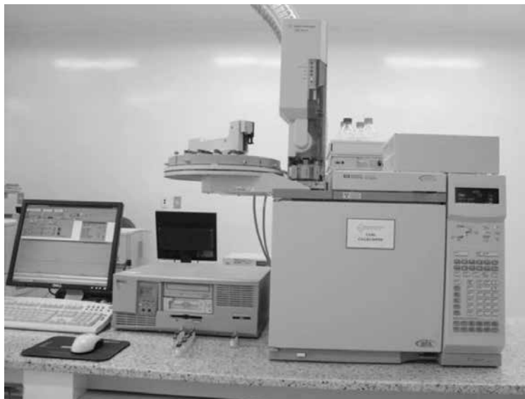
Figura 40 – Equipamento utilizado na Cromatografia Gasosa – Cromatógrafo a Gás
