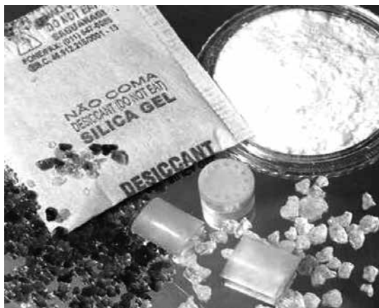
Figura 13 – Sílica em pastilhas utilizada para retirar umidade e sílica em pó utilizada na cromatografia
