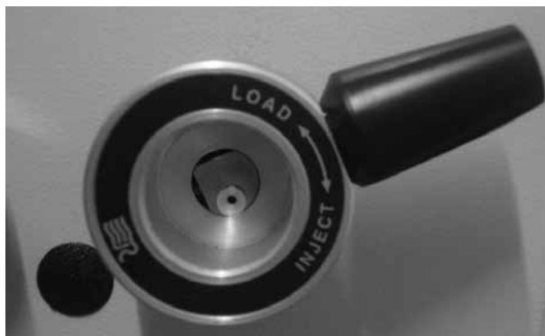
Figura 32 – Fotografia de uma válvula de amostragem para CLAE
