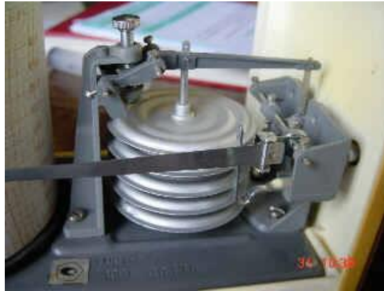
Figure 11 : Système des cinq capsules superposées, source [17]
