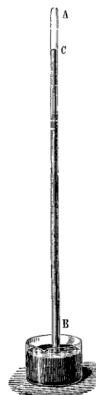
Figure 1 : Portrait d'Evangelista Torricelli vers 1647 par Lorenzo Lippi (1606-1665) et représentation de l'expérience de Torricelli, le baromètre à cuvette, sources [2] [3]
