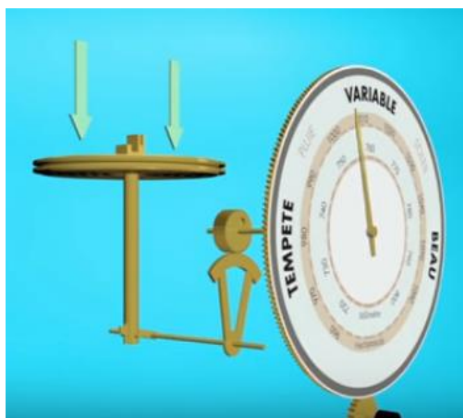
Figure 10 : Fonctionnement du baromètre anéroïde, image extraite de source [16]
