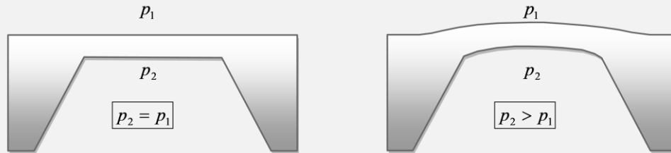
Figure B : Schéma de la déformation de la membrane d'un capteur de pression
