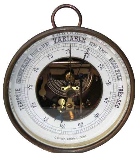
Figure 5 : Baromètre anéroïde du début du XX e siècle, source [10][11]
