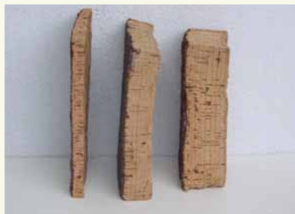
Δείγματα φελιού εννέα χρόνων ανάπτυξης με διαφορές στο πάχος και την ποιότητα (Πηγή: UNAC)
