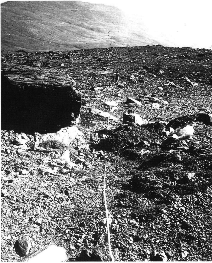
Abb. 15: Meßfeld 30. S-Seite des Mulhacén in 2950 m Höhe, S-Exposition, 18° Neigung, Glimmerschiefer, ungebundene Solifluktion, 220 m oberhalb Meßfeld 29; Holzpflocke und Steine wurden vermessen. Meßfeld offenbar gut durchfeuchtet infolge langer Schneeschmelzwasserzufuhr.
