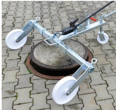
hydraulischer Deckelheber montiert
