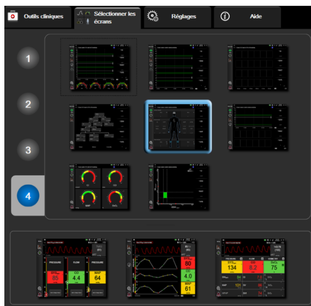
Figure 5-3 : Exemple de fenêtre de sélection d'un écran de surveillance
