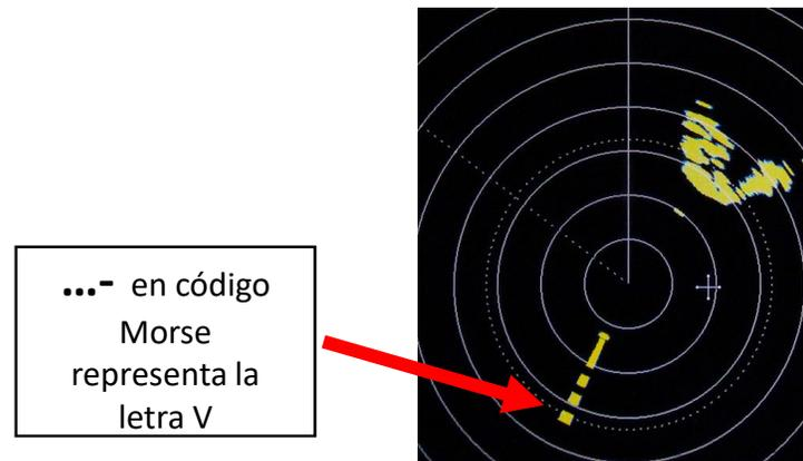
Existen dos tipos de RACON, los de barrido lento, los cuales están en periodos de desaparición y los de frecuencia ágil. La agilidad de frecuencias permite a los radares la variación de la frecuencia de trabajo seleccionando la que mejor se adecue tanto a las condiciones meteorológicas como al nivel de interferencia debido a otros radares.
