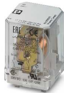
Hochleistungsrelais mit einem Schließerkontakt mit Blasmagnet zum Schalten hoher DC-Lasten
