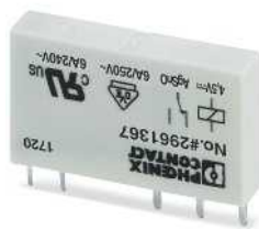
Relais mit einem Wechslerkontakt, max. 6 A
