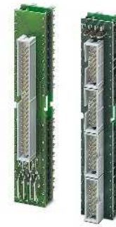
Frontadapter für SIMATIC® S7-300, I/O-Karten mit max. 32 Kanälen
