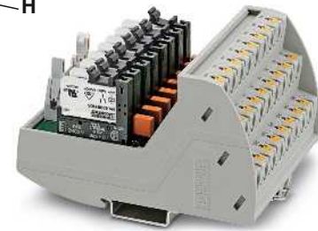
Ausgabemodul mit 8 Miniaturrelais, 1 Wechsler und Sicherung je Ausgangskreis
