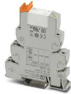
1-Schließer-Relaismodul mit zusätzlicher potenzialfreier Klemmstelle, max. 130 A peak
