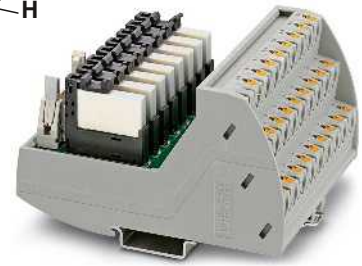
Digitaleingabemodul mit 8 Kanälen für 120 V AC
