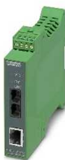
Universalgerät mit 1300 nm für Singlemode-Glasfaser
