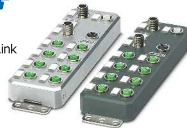
8 IO-Link-Ports, 4 digitale Eingänge
