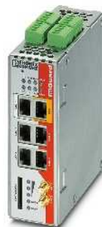
mit Firewall und VPN, managebarer 4-Port Switch, DMZ-Port und 2. WAN-Schnittstelle (US-Version)
