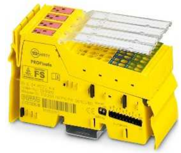
Digitales Ausgangsmodul, +/- schaltend
