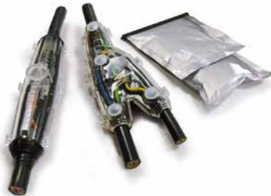
Die BBC Cellpack Gießharzmuffen bieten für unterschiedlichste Kabelarten und deren Querschnitte einen umfassenden Langzeitschutz in puncto Isolationswerte und Widerstandsfähigkeit. Denn die hochwertigen, ungefüllten 2-Komponenten-PUR-Gießharze sind für verschiedene Einsatzgebiete ausgelegt, ebenso wie die schlagfesten Kunststoff-Formschalen mit bzw. ohne integrierte Zugentlastung. Nach Aushärtung sind die Kabelgarnituren mechanisch und elektrisch vollständig belastbar.
