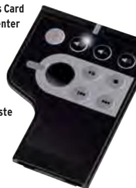
überbrückt bis zu zehn Meter. Der integrierte Akku des Presenters wird komfortabel aufgeladen: Dazu wird er einfach in den Express-Card 54-Slot des Notebook oder Tablet-PC geschoben – wo er auch gut aufgehoben ist. Der Laserpointer LR2 vereint Laserpointer, Kugelschreiber und Presenter. Über den beiliegenden USB-IR-Empfänger, der an das Notebook angeschlossen wird, steuert er aus sechs Metern Entfernung Powerpoint-Präsentationen oder Word-Dokumente. ■
