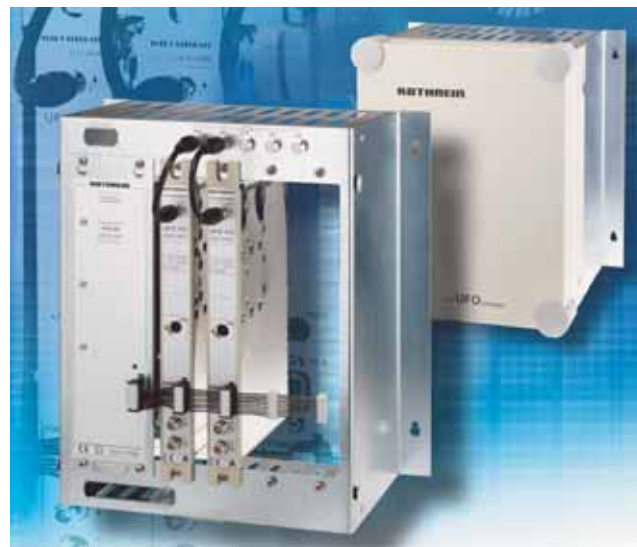
Das bewährte Kopfstellenprogramm UFOcompact wird um zwei neue Module ergänzt: UFO 395, einen 4-fach Umsetzer DVB-S2 auf PAL, sowie UFO 313, ein 8-fach DVB-Transcoder QPSK-UKW.
