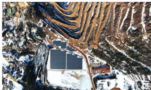
Bei der PV-Anlage am Erzberg zeigte sich, dass man die Untergrundbeschaffenheit stets im Auge haben sollte und man das Thema Statik – insbesondere dort, wo extreme Wind- und Schneelasten auftreten können – nicht auf die leichte Schulter nehmen darf. Ein Besichtigungs-Tipp für Interessierte: Die PV-Anlage ist zwar nicht öffentlich zugänglich, bei einer Wanderung auf den Reichenstein bietet sich jedoch ein imposanter Überblick.
