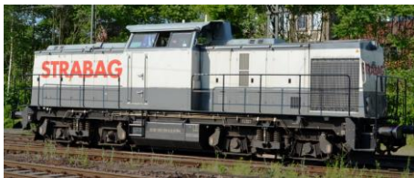
Abbildung 43: V 100 (Ost) Umbau auf Baureihe 203 (Paul Smith, CC BY 2.0 , Link , Bildausschnitt)
