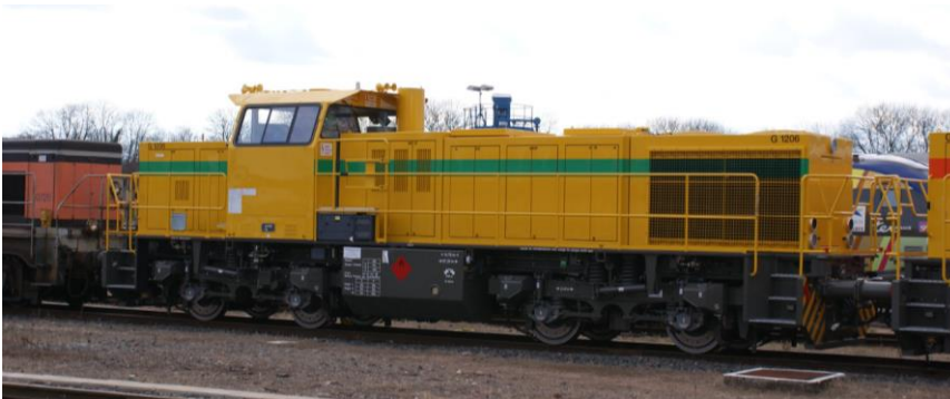
Abbildung 27: MaK G 1206 - Dieselhydraulische Rangierlokomotive von Hugh Llewelyn. Lizenz: CC BY-SA 2.0 (Bildausschnitt)
