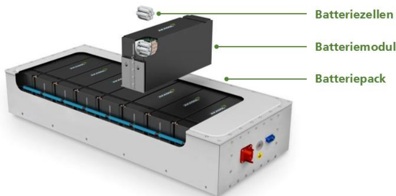
Abbildung 20: Beispielhafte Zusammensetzung eines Batteriepacks (Bildquelle: (Akasol 2021), Zusammensetzung eines Batteriepacks)
