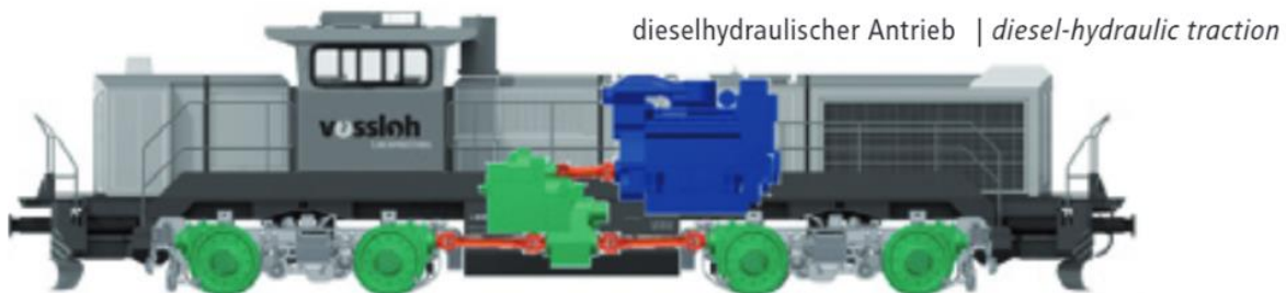
Abbildung 28: Aufbau Vossloh Locomotives G 18 mit dieselhydraulischer Leistungsübertragung, der Aufbau einer MaK G 1206 ist vergleichbar, Abbildung: (Vossloh Locomotives o.J.)
