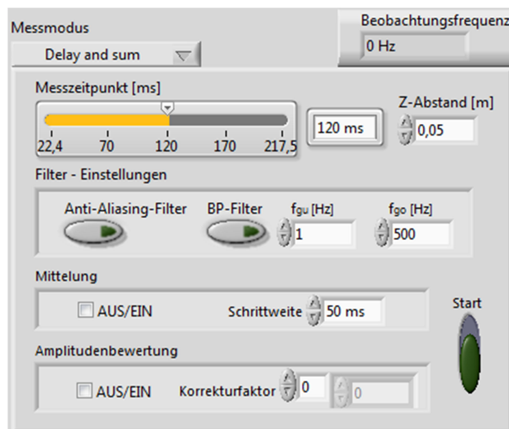
Abbildung 5.11: Messmodus – „Delay and sum“
