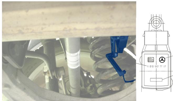
Abb. 3.6: links - Photo des Federwegsensors (blau) aus dem Versuchsfahrzeug, rechts - technische Skizze nach [20]
