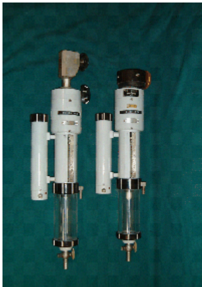
[1.] Hidrosztatikai szintező és a hidrosztatikai szintezés alapelve
