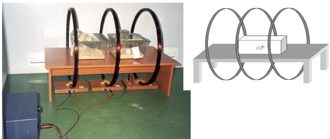
Figura 15. Dispositivo experimental para la exposición a un campo magnético.
