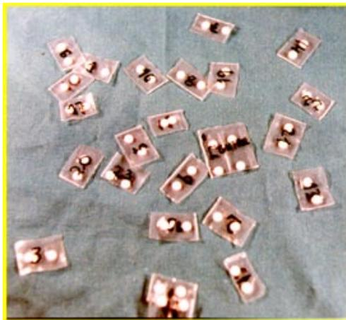
**Figura 13. Dosímetros de termoluminiscencia**
