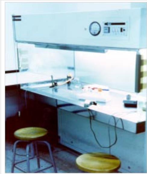
**Figure 5. Cabina de flujo laminar usada para la manipulación y cultivos de linfocitos de sangre.**
