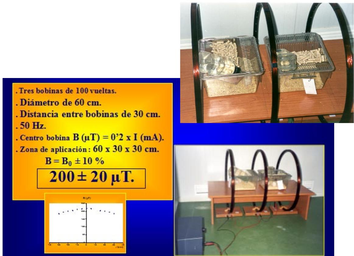
Figura 16. Dispositivo experimental para la exposición a un campo magnético de 50Hz.
