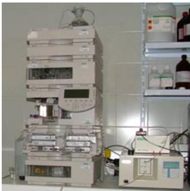
**Figura 8. Equipo de cromatografía líquida de alta resolución (HPLC)**
