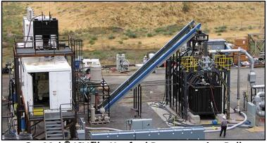
GeoMelt<sup>®</sup> ICV <sup>™</sup> – Hanford Demonstration Bulk Vitrification System (DBVS): 50 ton Melts, USA
