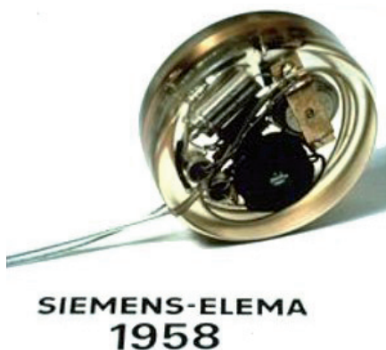
Figura 2. Primer marcapasos insertable (Curso práctico intensivo de estimulación cardiaca. Dr. Fco. Javier Tejada. SES).
