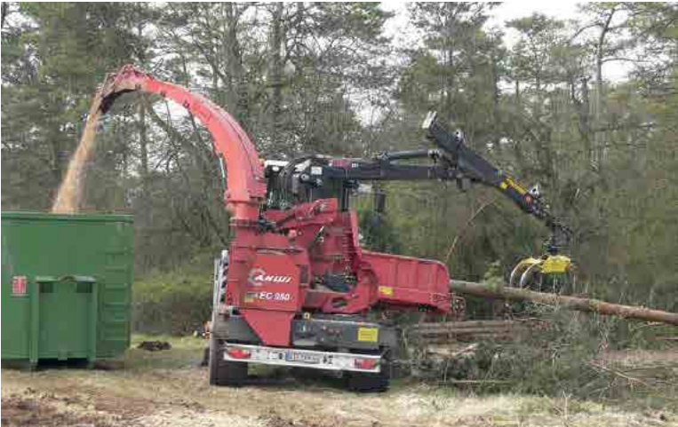
Abb. X.4.f: Produktion von Hackschnitzeln aus dem angefallenen Starkholz direkt vor Ort
