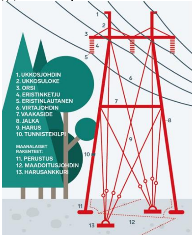
Kuva 8. Voimajohdon maanpäälliset ja maanalaiset rakenteet (Fingrid.fi, 2022)
