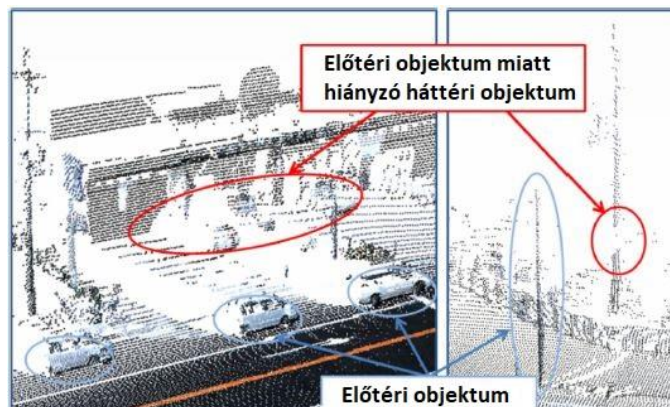
19. ábra: Kitakarás mobil térképező rendszer pontfelhőjében
