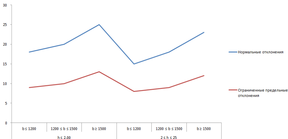
Рис. 4. Требования по плоскостности согласно EN 10051-10
