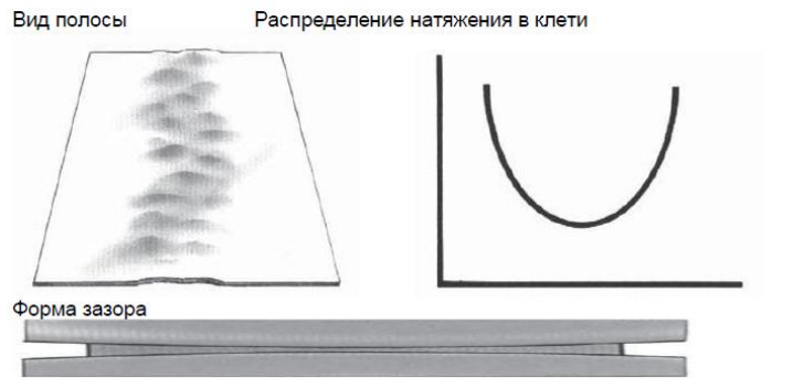
Рис. 1. Корбоватость центра полосы
