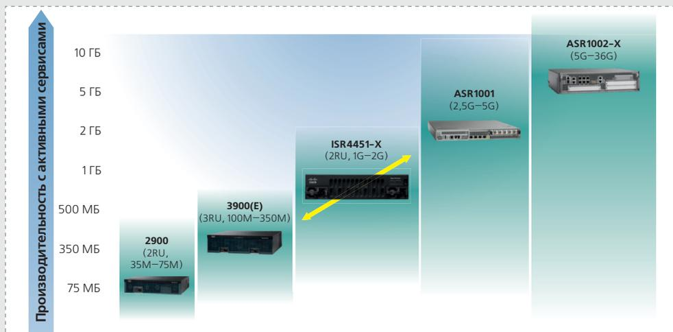
Маршрутизатор ISR4451-X закрыл нишу между классической линейкой ISR G2 и мощными ASR
