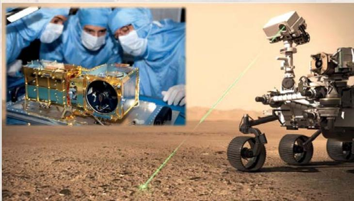
Fig. 3. Ilustración del funcionamiento del instrumento *SuperCam* (ablación láser en rocas) de la misión *Perseverance* de la NASA y fotografía del mismo instrumento durante su ensamblaje. Imagen de CNES (Centre National d'Études Spatiales, Francia).
