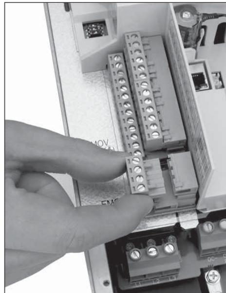
**Note:** Für einen leichten Zugang können die Klemmenblöcke der Karten für die Verdrahtung getrennt werden.
