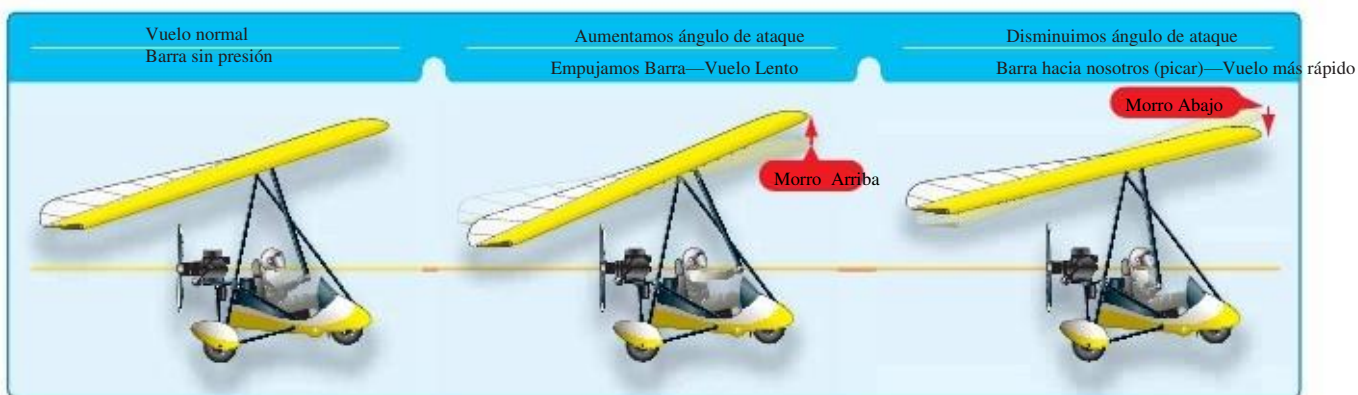
Figura 6-2. Efecto de la barra de control sobre el ángulo de ataque y la velocidad.
