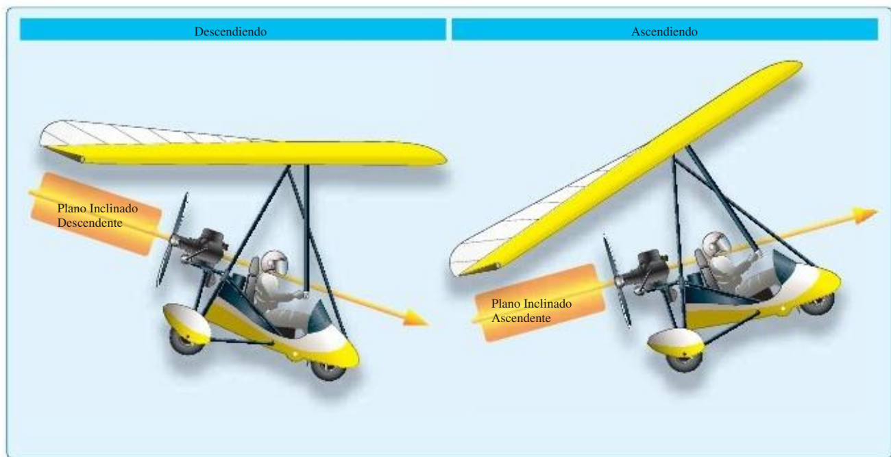
Figura 6-13. Cuando el trike se estabiliza en ascenso o en descenso, las senda que describe es un plano inclinado.
