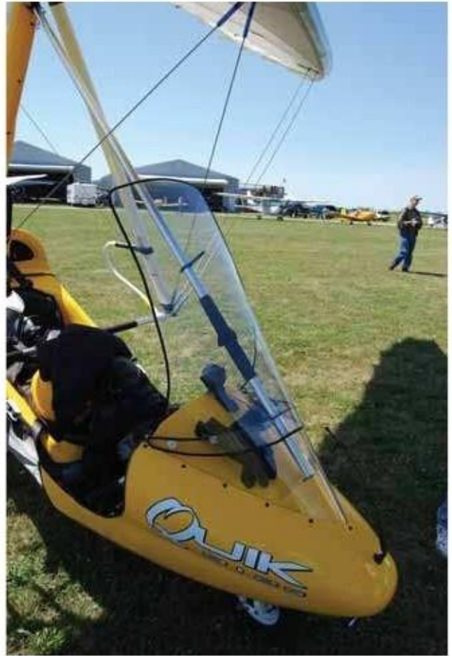
Figura 6-4 El parabrisas impide al viento golpear al piloto
