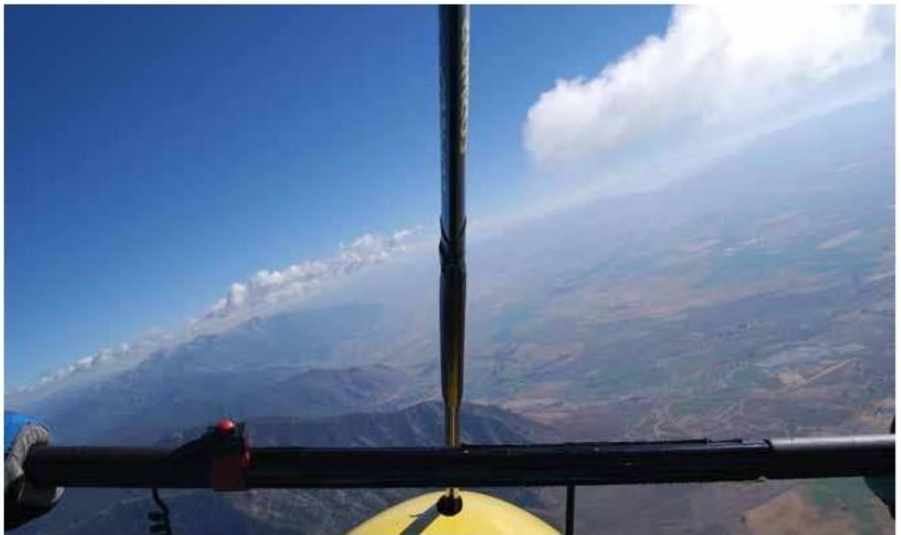
Figura 6-18. Referencias visuales del piloto en alabeo y profundidad—continuación del descenso en giro pronunciado pero aumentando el ángulo de ataque aplicando algo de potencia. Notar cómo el tubo frontal se ha desplazado a lo largo del horizonte y el morro ha ascendido ligeramente aplicando ligeramente potencia para nivelar el vuelo.
