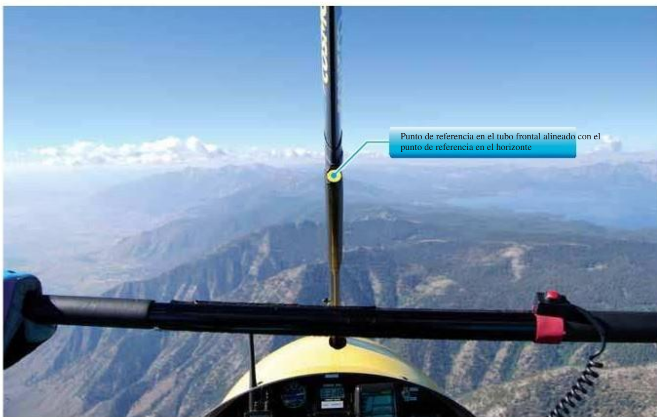
Figura 6-7. Punto de vista del piloto, alineando el punto de referencia del tubo frontal con un punto de referencia en el horizonte, para vuelo recto y nivelado
