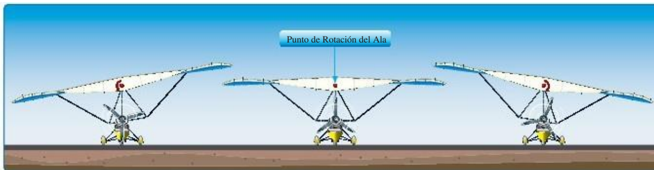
Figura 6-1. Diagrama del banco de un ala
