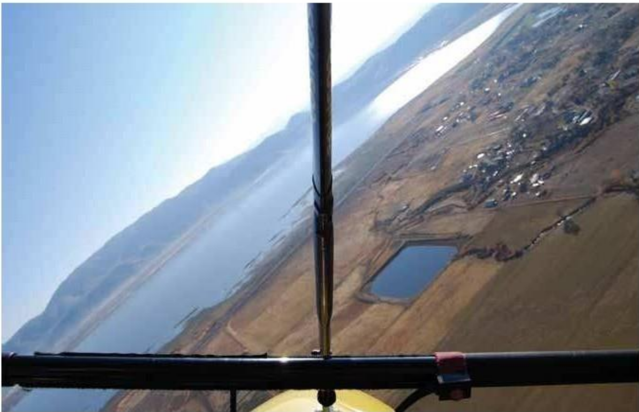
Figura 6-5. Punto de vista del piloto de un alabeo a 45°, que puede ser medido por el ángulo del tubo frontal (o la barra de control) con el horizonte.
