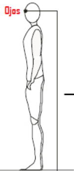
Piso Figura 4. Altura de ojos.
