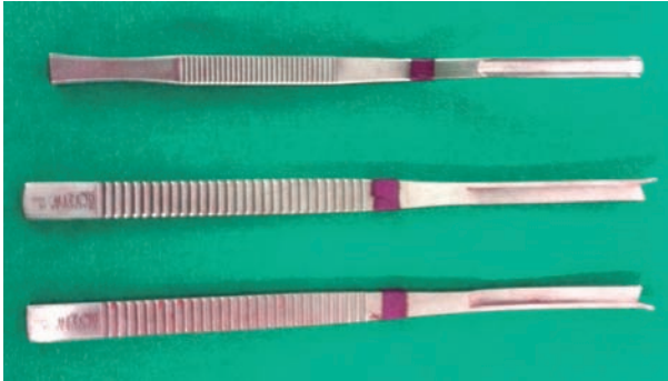
Escoplos de suelo con detalles de su zona de corte.
