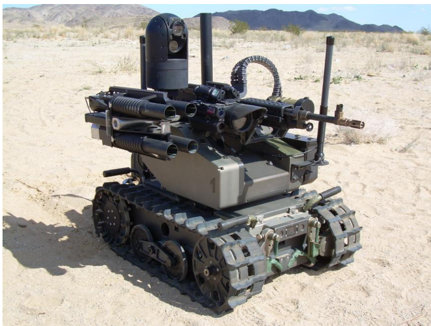
Sistema modular robótico armado avanzado (no tripulado pero controlado por un humano a distancia).
