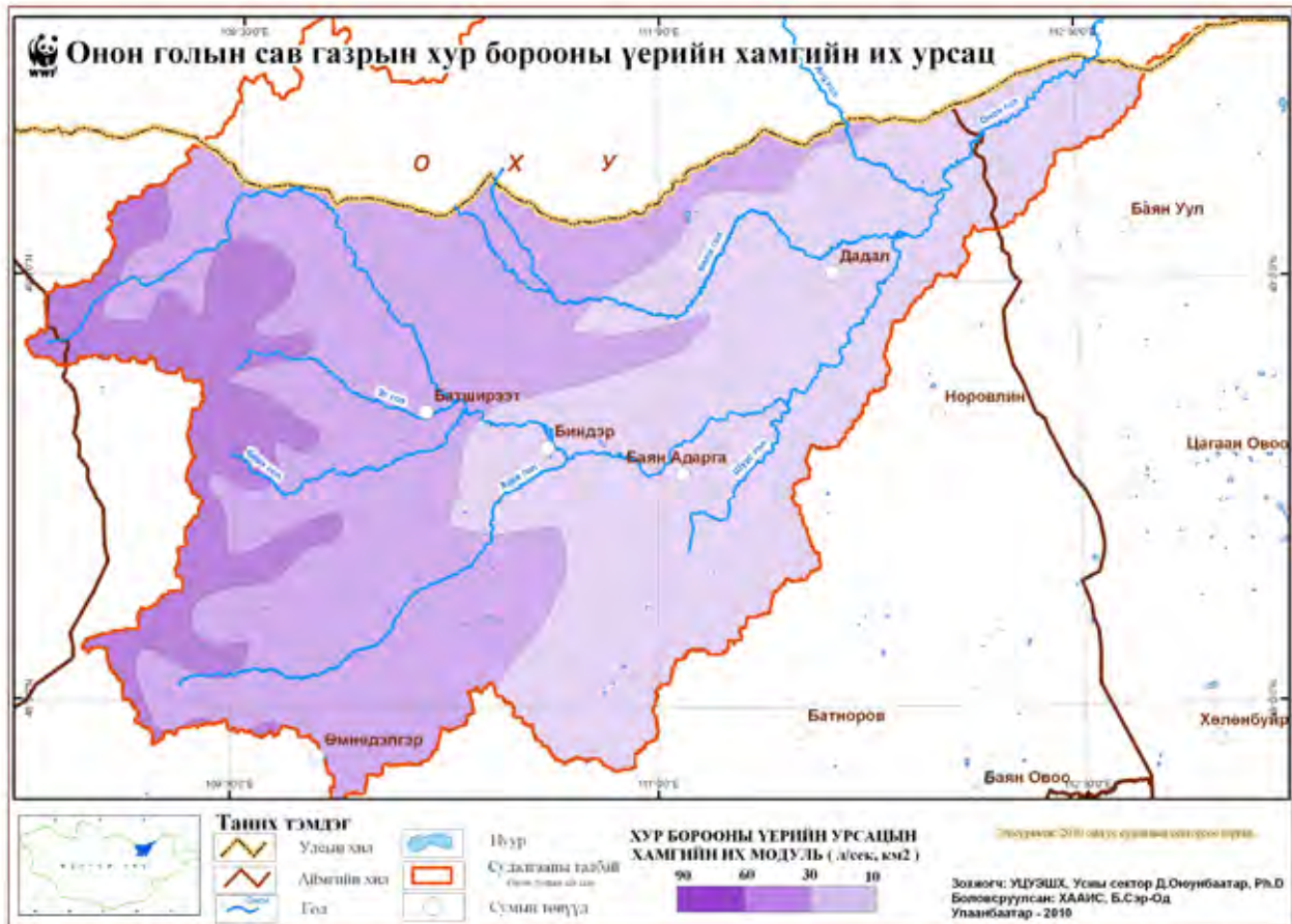
3.6 дугаар зураг. Онон голын сав газрын 1 хувийн хангамшилтай хур борооны үерийн орон зайн хуваарилалт, л/сек км 2
