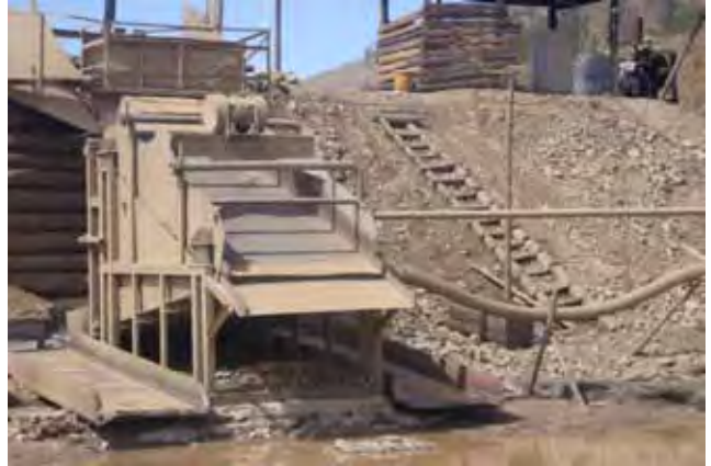
6.11 дүгээр зураг. Батширээт сумын Гутайн голд алт олборлож байгаа “U&Vi” ХХК-ийн ашиглаж байгаа алт угаах төхөөрөмж
