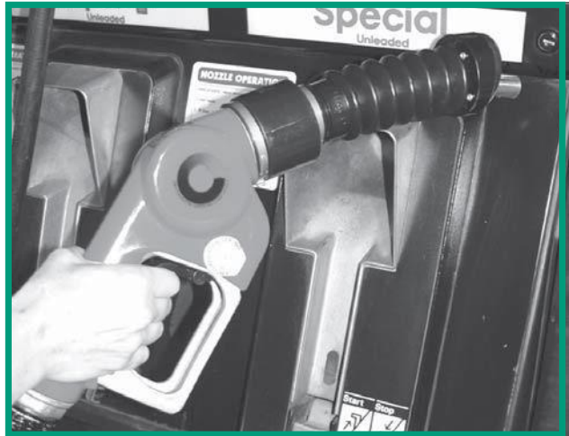
La Ley de Aire Limpio requiere la instalación de boquillas de recuperación de vapor en estaciones de servicio en ciertas áreas. Estas boquillas de bomba de gas reducen la liberación de vapor de gasolina al aire cuando las personas cargan gasolina en los automóviles.
