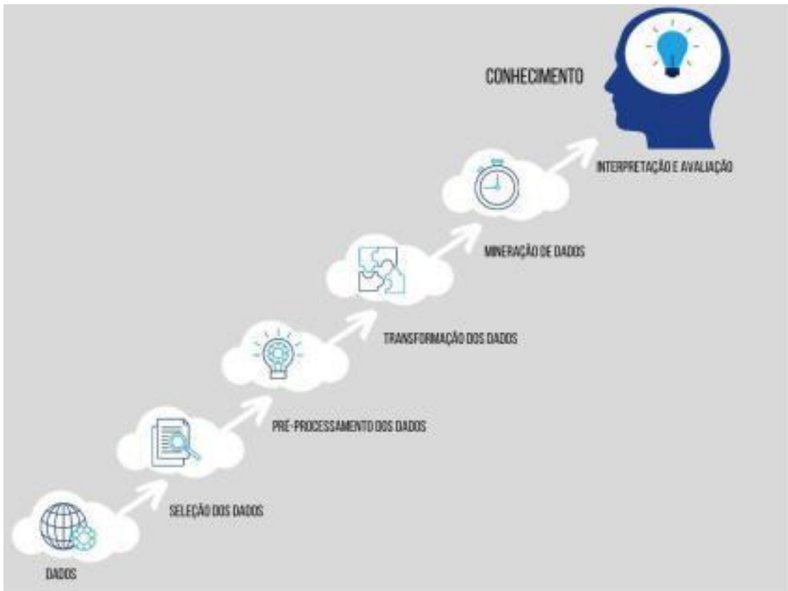
Figura 2.1. Panorama dos passos que compõem o Processo de Descoberta de Conhecimento em Dados (KDD)
