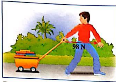
El niño hace una fuerza de 98 N con dirección horizontal en sentido hacia su izquierda.
