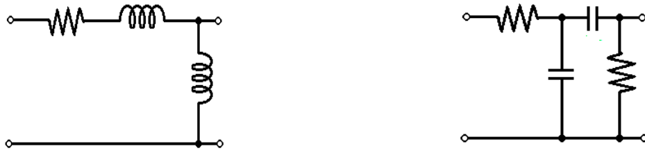
Figura 4.1 Se comparan circuitos de sistemas de primer y segundo orden con varios elementos reactivos, es importante analizar el circuito y procurar reducir los elementos del mismo tipo siempre que se pueda, para esto se sugiere analizar la conexión de los elementos del circuito.
