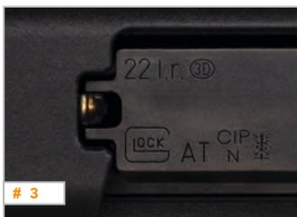
**INDICADOR DE RECÁMARA CARGADA:** (Agujero fantasma): La apertura localizada en la parte superior - trasera del cañón (Foto 1) funciona como indicador de recámara cargada en cumplimiento de leyes de algunos estados de los EE.UU. Mirando por la apertura localizada en el parte superior - trasera del cañón es posible que pueda observar la presencia de munición y determinar si la recámara esta cargada. (Recámara descargada – Foto 2 / Recámara cargada – Foto 3).
