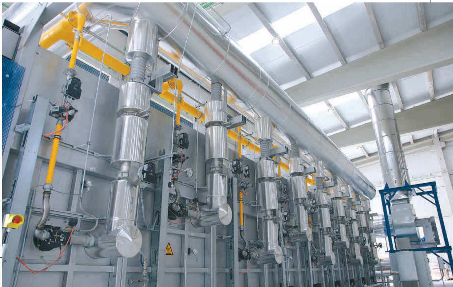
Horno de cocción de conformados en la nueva planta de Refracta en Ribarroja del Turia (Valencia), a punto de inaugurarse
